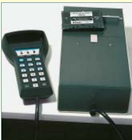
Erste Generation des Bestellterminals „Datakap“
