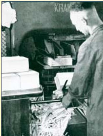
Beschneiden des Buchblocks im Dreischneider
